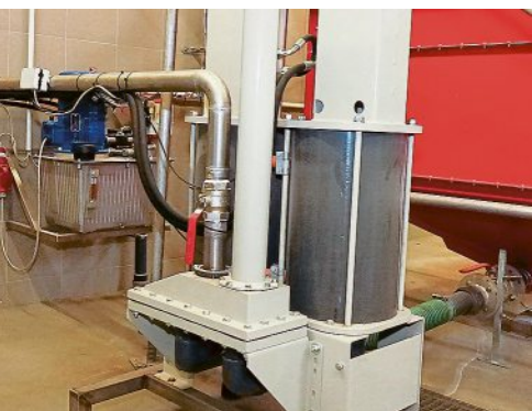
Doppelkolbenpumpen sind teurer, aber robust und leistungsstark. Sie werden von einem Hydraulikaggregat angetrieben.
