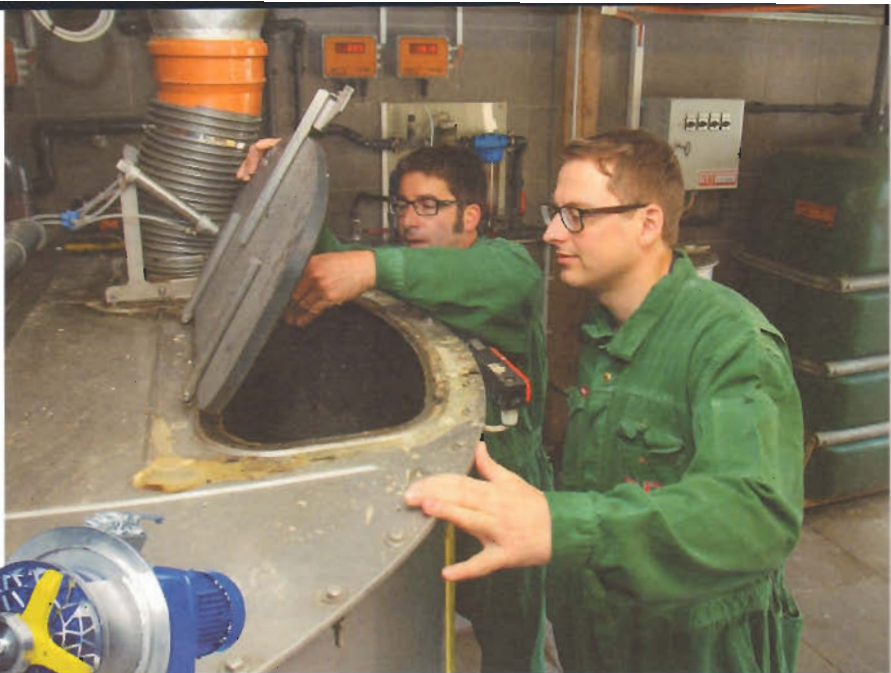
Die Flüssigfütterung saugt das Wasser-Maissilage-Gemisch selbsttätig aus dem Vorratsbehälter.
