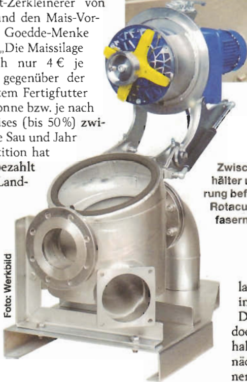
Die Flüssigfütterung saugt das Wasser-Maissilage-Gemisch selbsttätig aus dem Vorratsbehälter.
